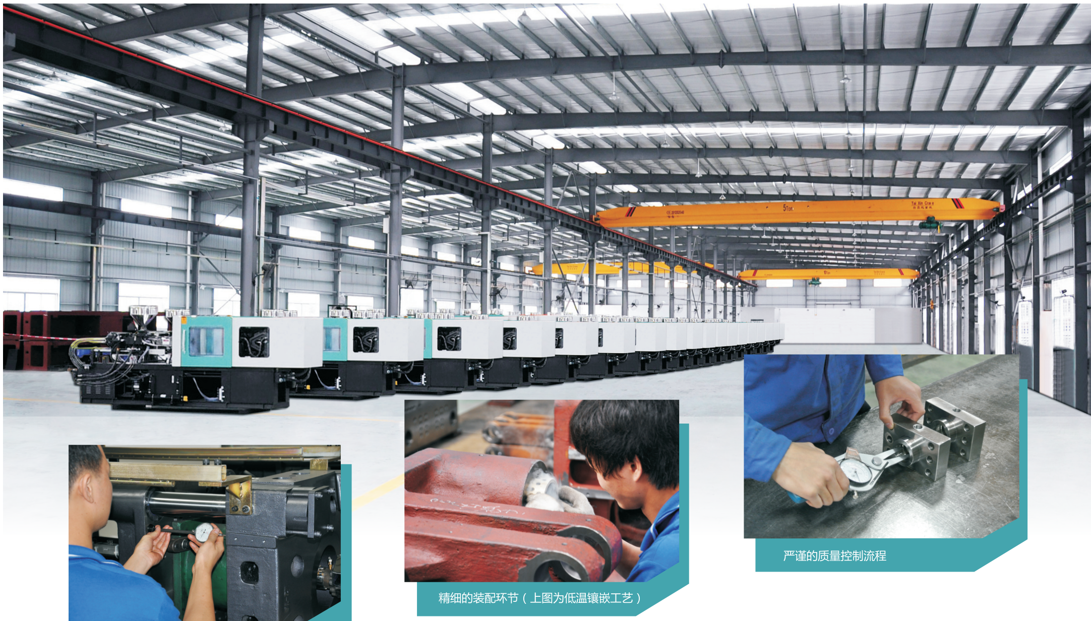
整机运行后检测模板平行度环节
